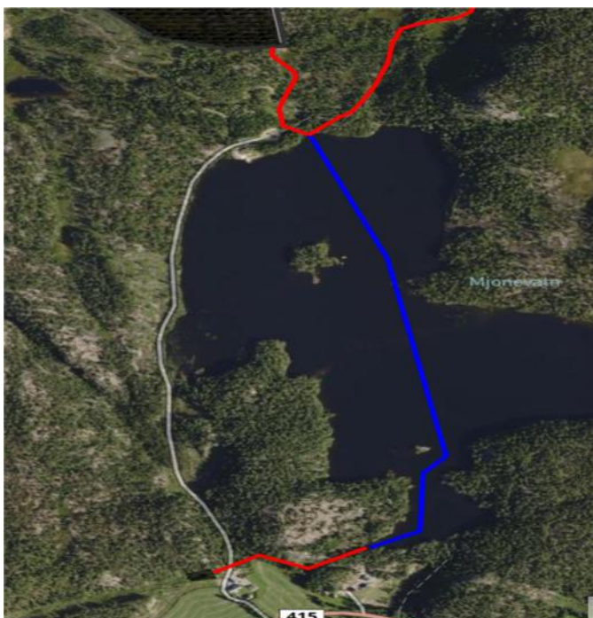
Figur 29 Framføringstraséerkraftkabel - blått sjøkabel, rødt jordkabel
