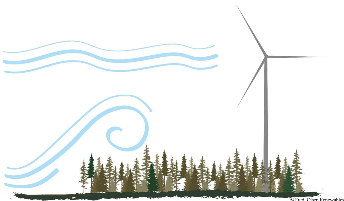
Figur 3. Högre totalhöjd möjliggör större rotordiameter och därmed större svepyta, vilket innebär att mer energi kan utvinnas.
